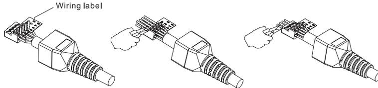
④ Place wiring cap on plug.
